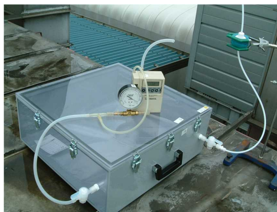
写真4 揮発性有機化合物採取用箱（箱内に採取袋）
