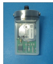
写真2 新温度計 高さ58mm × 幅33mm × 厚さ 23mm、重さ18g
