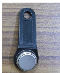
写真1 旧温度計 直径約17mm × 厚さ約6mm、 重さ約3.3g
