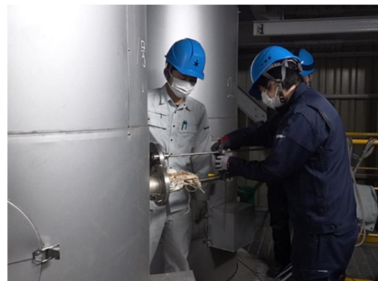
写真 4 煙道での測定の様子
