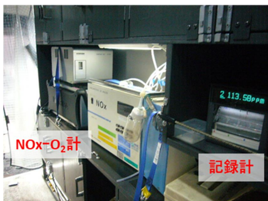
写真 3 ばい煙測定車内の主な測定機器(2)
