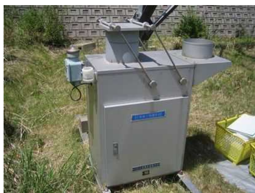
写真 1 降水時開放型降水採取器
