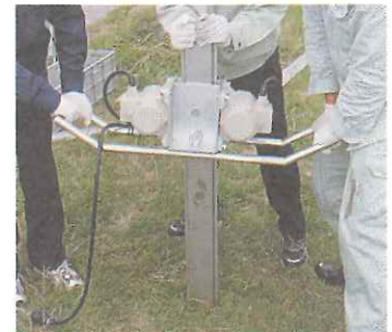
写真3 ハンディジオスライサー採土器
