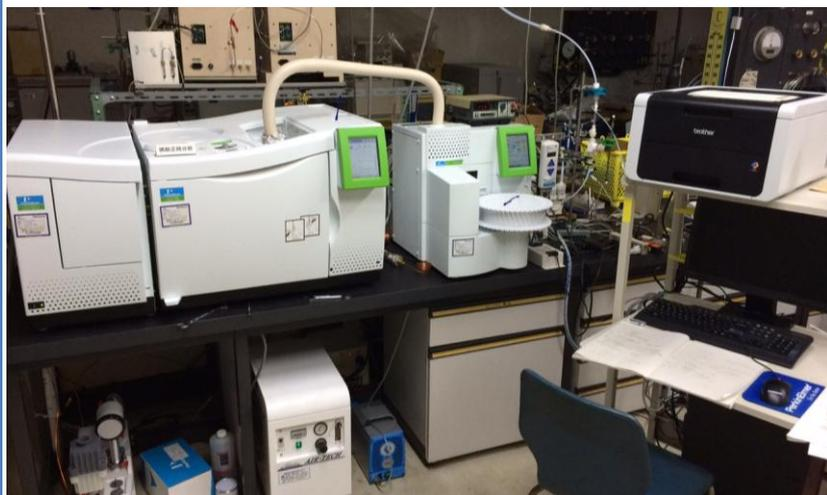
外気を装置内の捕集管に濃縮させてから、ガスクロマトグラフ質量分析計に送り込んで自動連続分析を行っています。2 時間間隔で 1 時間捕集し、1 日 12 検体について、ベンゼン等の VOC 58 物質を分析しています。
