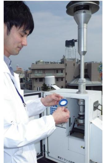
図 1 PM<sub>2.5</sub>採取装置
