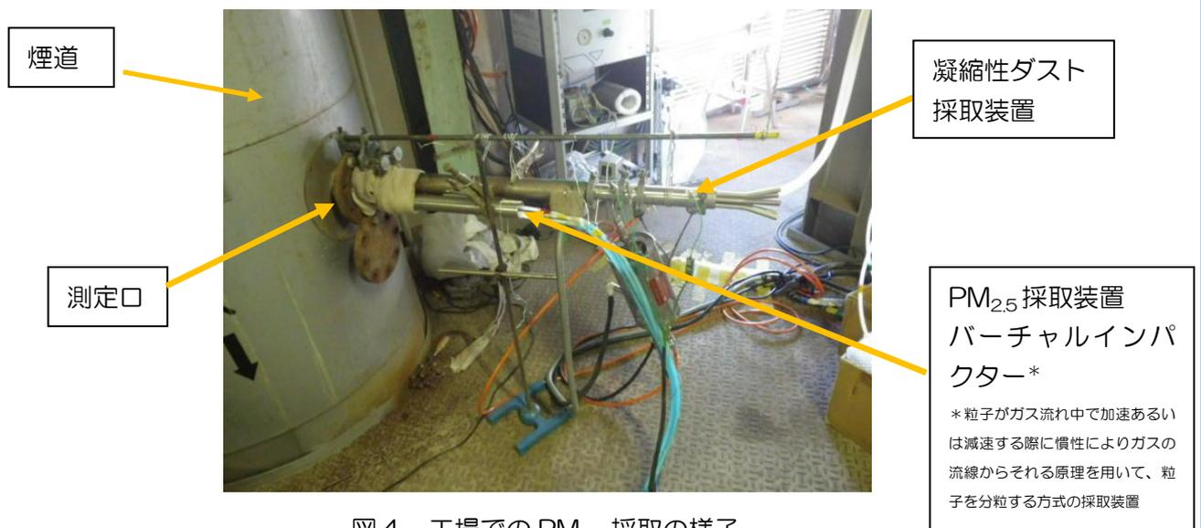
図4 工場でのPM<sub>2.5</sub>採取の様子
