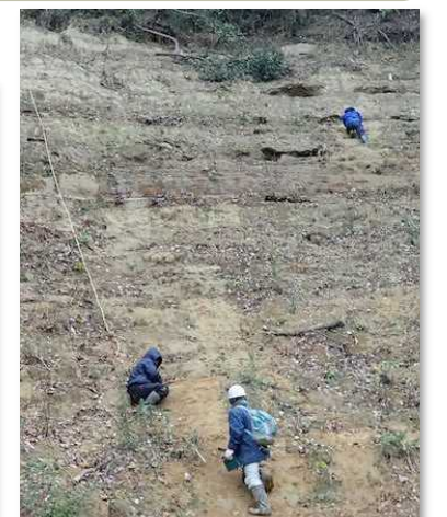
地質構造や透水層構造把握のための地質調査
