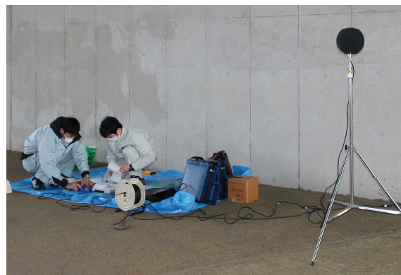
現場での騒音測定調査
