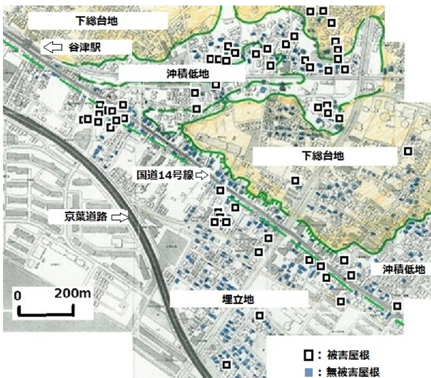
図 1 習志野市谷津地区の瓦屋根被害分布
