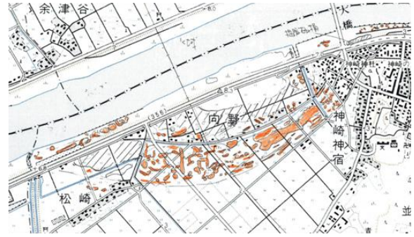
図2 2011年東北地方太平洋沖地震による香取市神崎町小松飛地周辺の液状化・流動化分布。(塗りつぶし部分：噴砂および亀裂，斜線部分：沈下による水たまりと小さな噴砂)
