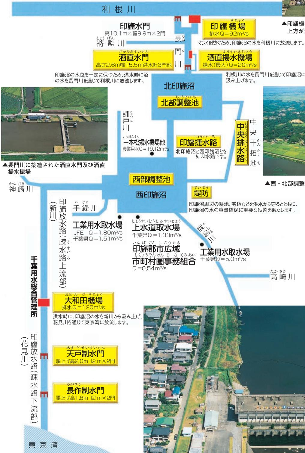
印旛沼の水位を一定に保つため、洪水時に沼の水を長門川を通じて利根川に放流します。
