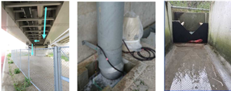
北千葉道路で降雨調査を実施し、全窒素濃度及び流量を測定
