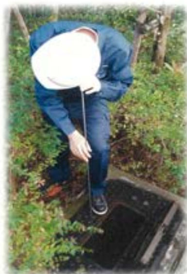
漏水調査：水道管から伝わる音だけをたよりに漏水を見つけます。
