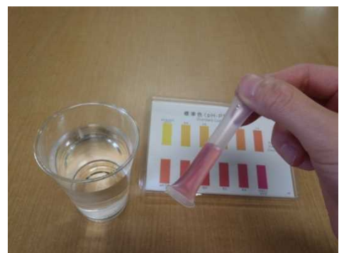
図3-19 簡易キットによる水質検査
