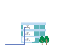
【直結直圧式給水方式】
