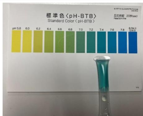
図 2-1-2 簡易水質検査 (pH)
