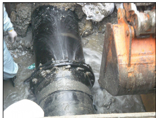
図7 東日本大震災の液状化で漏水した管路
