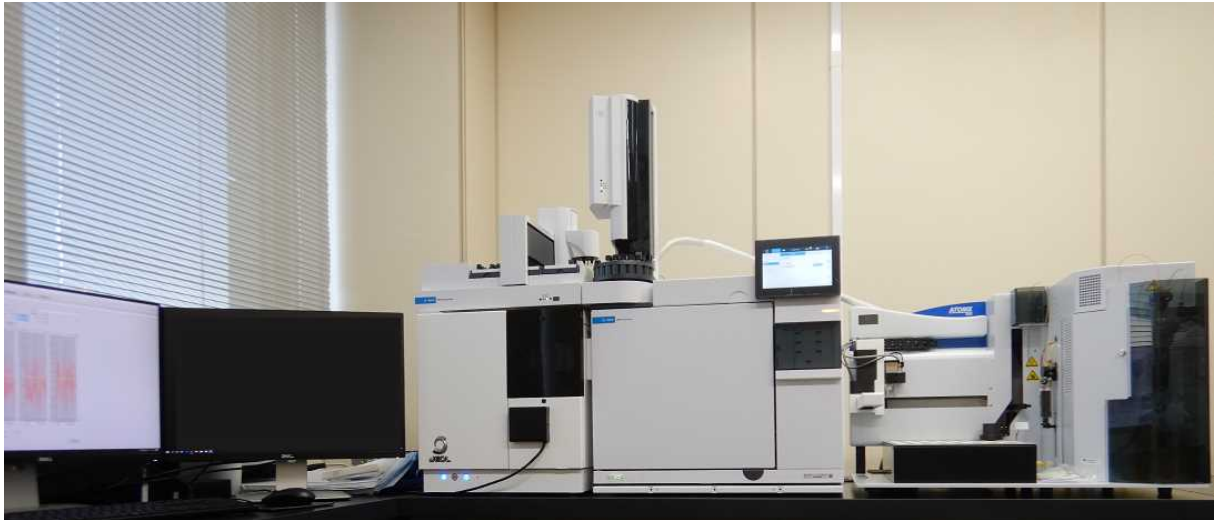
トリプル四重極型ガスクロマトグラフ質量分析計（令和元年度・水質センター導入）
