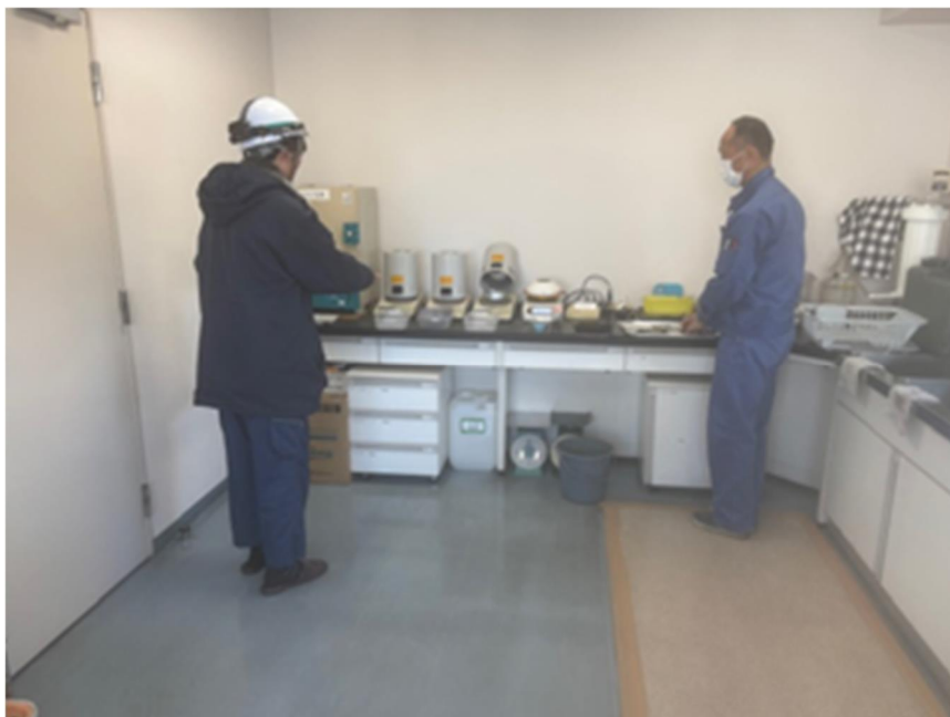
写真 9 含水率測定用乾燥機の確認 (発生土含水率計器値確認)
