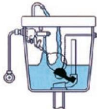
②レバーを回すとゴムフロートが開き、水が流れ出します。水面が下がると浮玉も下がり、ボールタップの弁が開いて給水がはじまります。
