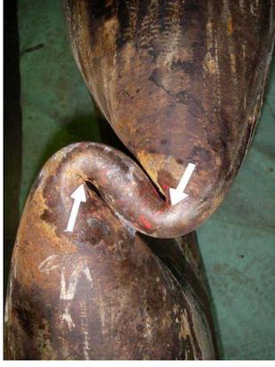
写真4 ガソリン配管(直径14インチ)の屈曲部と割れ(矢印2箇所)
