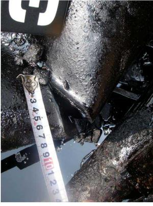
写真3 重油配管の開口部
