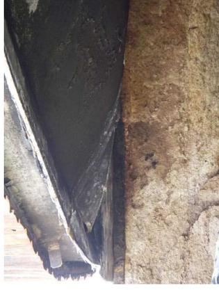
写真 24 硫黄タンクの底板の破断部
