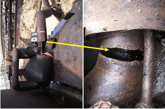
写真6 破断した重油タンクの配管
