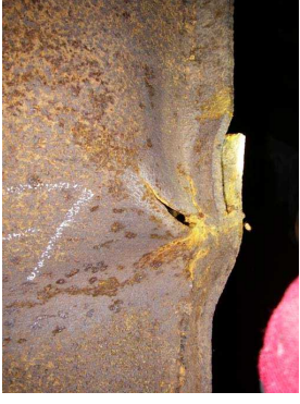
写真 43 ポンツーンの破断部（アウトタームとローアードデッキの溶接線近傍）
