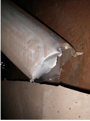
写真48 破断したフロートチューブ2
