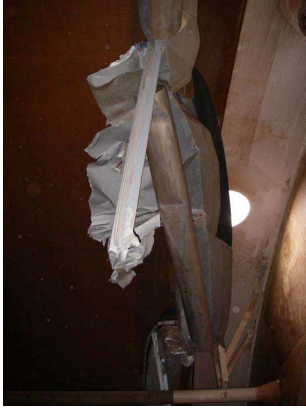
写真49 破断したクランプビーム
