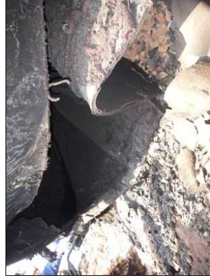
写真 19 ガソリントタンク破断部
