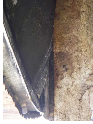
写真 24 硫黄タンクの底板の破断部
