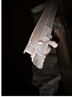
写真50 破断クランプビーム先端部拡大
