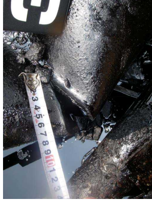
写真3 重油配管の開裂部
