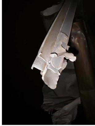
写真50 破断クランプビーム先端部拡大
