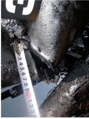
写真3 重油配管の開口部
