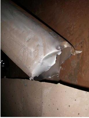
写真48 破断したフロートチューブ2
