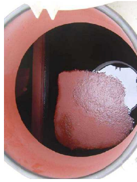
写真 39 ポンツーン内への原油の満油
