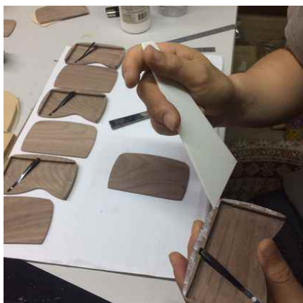
パネ内蔵の板を組付け
