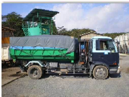
アームロール車を利用した堆肥燃料の輸送
