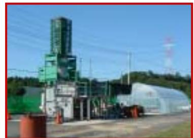
また、炭化試験施設(写真)背後にある施設は、炭化時に発生する排熱の利活用についてデータを収集するための排熱利用施設で、今後、炭化試験と併行して排熱利用試験も実施される予定です。
