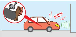
停止時や低速走行時に、車載レーダー等が壁などを検知している状態でアクセルを踏み込んだ場合、エンジン出力を抑え、急加速を防止。
