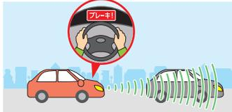
車載レーダー等で車両などを検知し、警報で知らせる。衝突の可能性が高い場合は、自動ブレーキを作動。
