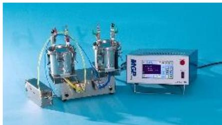
2液混合タイプの接着剤を高精度かつ微量吐出可能な装置を製造・販売している会社。本展示品は、業界最高水準の最小吐出量 0.5mg を実現したもので、微小な電子部品の接着等に活用されている装置。
