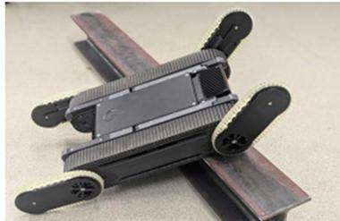
ソフトウェアからハードウェアまで、ロボットとその周辺機器等を開発する会社。本展示品は、狭隘空間における点検作業を安全かつ効率的に行うために開発したもので、高い走破性能を持つ小型点検クローラロボット。
