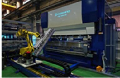
プレス装置や板金工作機械を製造・販売する会社。本展示品は、図面データから複雑な曲げ順とロボットの動線を自動生成でき、さらにオフラインでのシミュレーションも可能な、生産段取り時間を大幅に削減できる製品。
