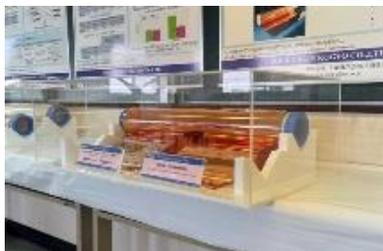
グラビア印刷機や真空成膜装置を設計・製造する会社。本展示品は、特殊な表面改質技術を用いてフッ素樹脂に銅膜を密着させることにより、絶縁性を高めたもので、高速データ通信機器への活用が可能な高機能フィルム。
