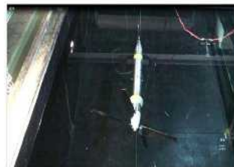
2重反転タービン1MW級装置の1/60模型による先行研究の様子
