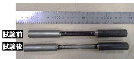
【測定例】 4号試験片の引張試験 ※上の写真は、試験前後の写真。 右の写真は、測定画面。
