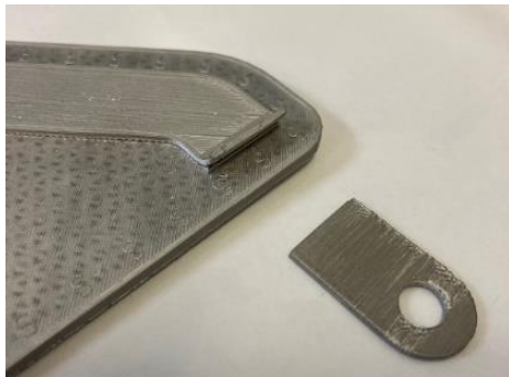
図7 薄板造形の不良
