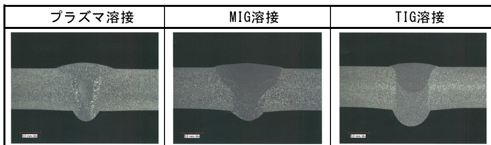
写真2 溶接部の断面マクロ写真
