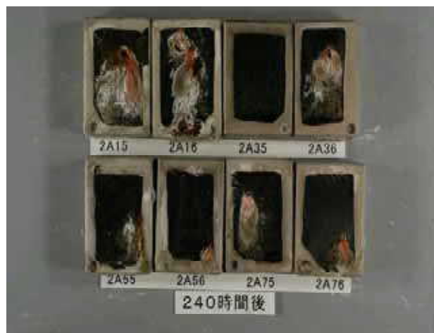
写真5 A2017-Niめっき品の塩水噴霧試験結果
