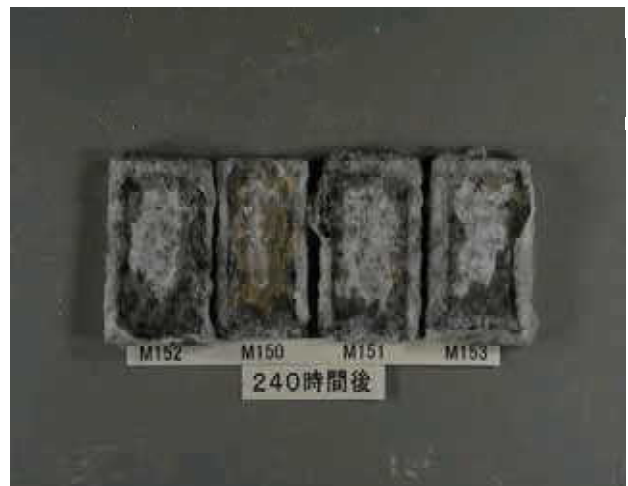
写真10 Mg合金素材MC2Bの塩水噴霧試験結果
