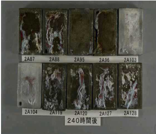
写真7 A2017一溶射品の塩水噴霧試験結果
