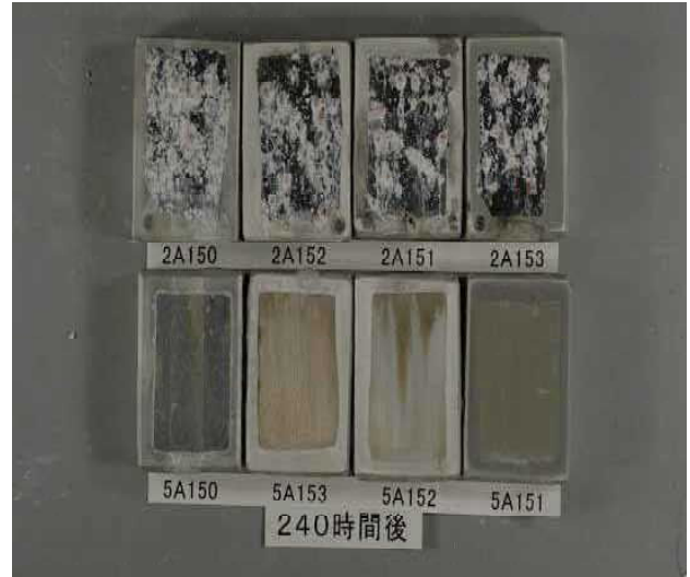
写真9 Al合金素材の塩水噴霧試験結果 (写真上列：A2017, 写真下列：A5052)
