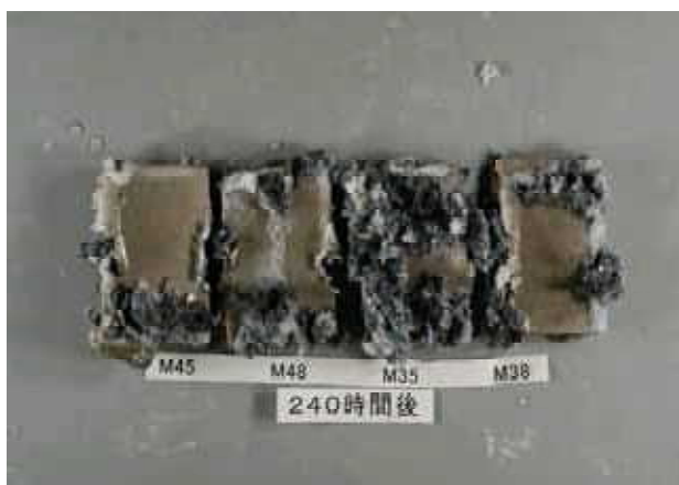
写真6 MC2B-Niめっき品の塩水噴霧試験結果
