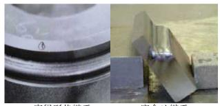
実径形状継手 突合せ継手 写真2 バタリング溶着金属の外観
