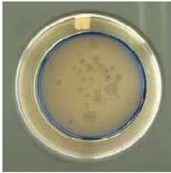
写真9 生成したハローの状態 平蔵 PHB 7日目
