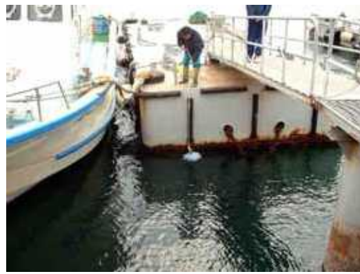
写真2 試験地(千葉港)の遠景(左), 試験片の設置状況(右)
