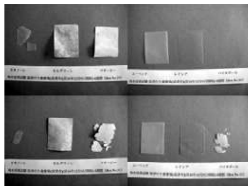
写真5 浸漬した試験片の状態，富津沖2週間後(左)，4週間後(右)
