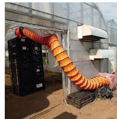
外気導入によるハウス内温度抑制実証試験
