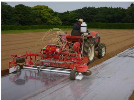
写真1 供試した接着剤式全面マルチ土壤消毒機
