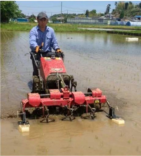
写真1 動力型中耕除草機
