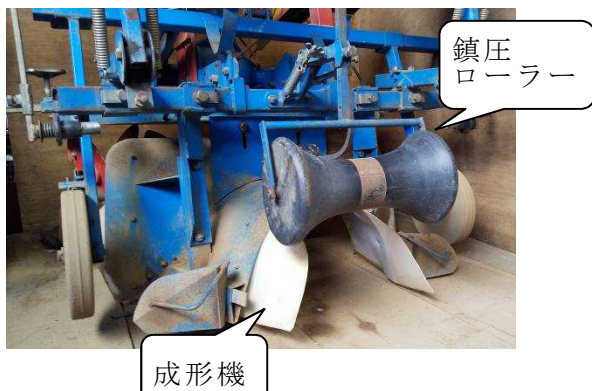
写真1 ヤマトイモ高畝栽培で使用する高畝成形機と鎮圧ローラー
