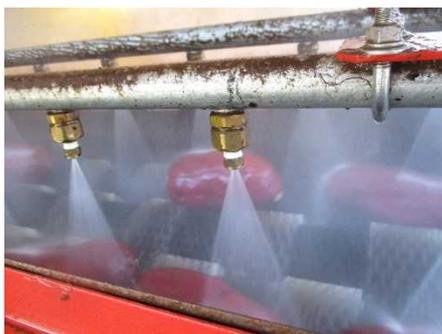
写真IV-5 サツマイモ洗浄機の洗浄部
