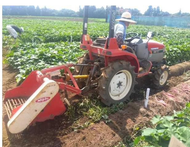
写真Ⅱ-27 コンベア式収穫機
