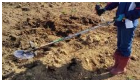
【図4-18：刈払機の操作の仕方】
