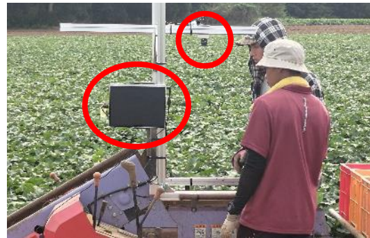
収穫機に装着したAIカメラと通信端末
