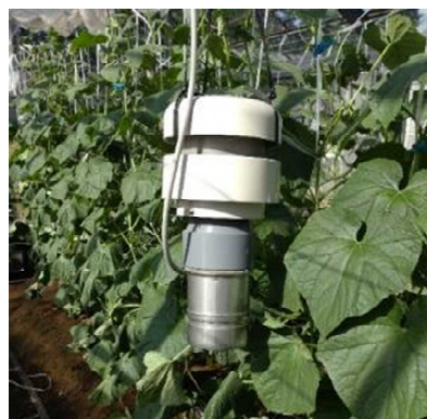
気温は通風筒を用いて正確に測定
