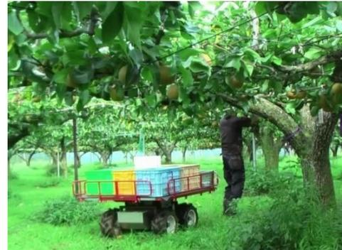
自動追従ロボット台車での収穫
