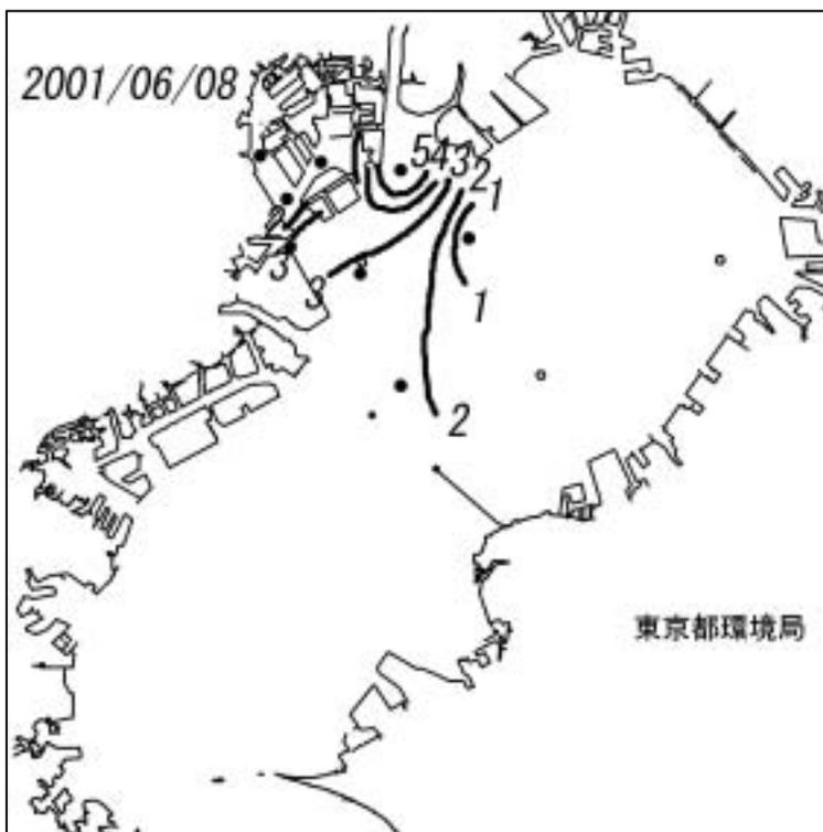
図6 底層の溶存酸素量分布 (ml/L)
