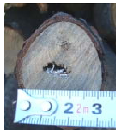
写真 - 10 木口に見られる孔道
