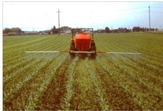
写真8 ブームスプレーヤでの除草剤散布 （トウモロコシ圃場における茎葉処理）
