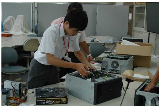
マザーボード組み込み
