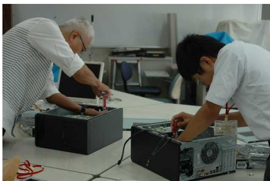
HDD 等の組み込み
